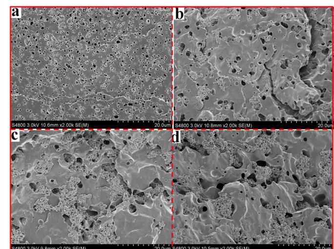
Fig. 2. SEM images of IPC samples annealed at 210 °C for different time. (a) 0 min, (b) 10 min, (c) 20 min, (d) 30 min.
