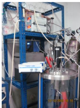
图 3: CO 2 聚合用高压反应釜 (10MPa)。
