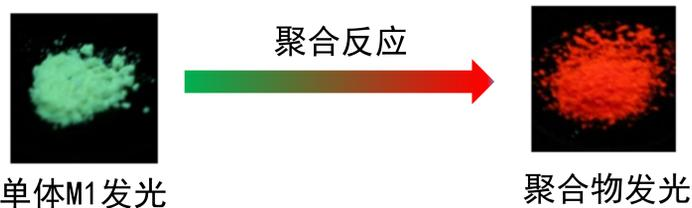
图2. 聚合过程伴随着显著的外观颜色和荧光颜色变化。
