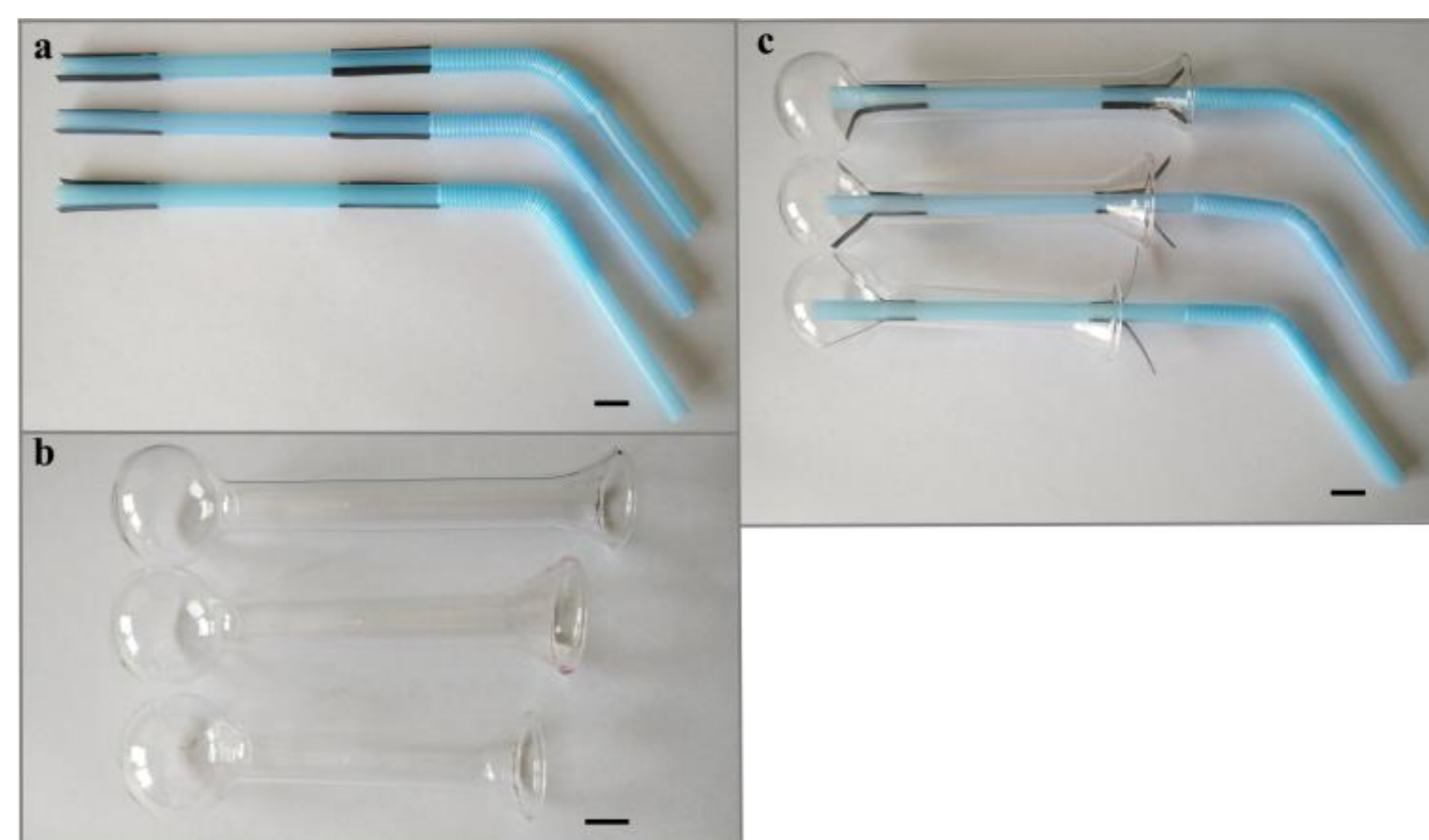
图5. 通过调节光照, 对材料的三维形状进行按需调控。标尺: 0.5cm
