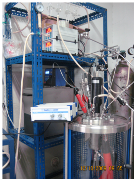
图 3：CO 2 聚合用高压反应釜（10MPa）。
