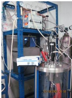
图 3: CO<sub>2</sub> 聚合用高压反应釜 (10MPa)。
